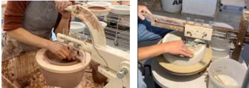
[그림] 작업자에 따라 압력 조절 영향 예시
