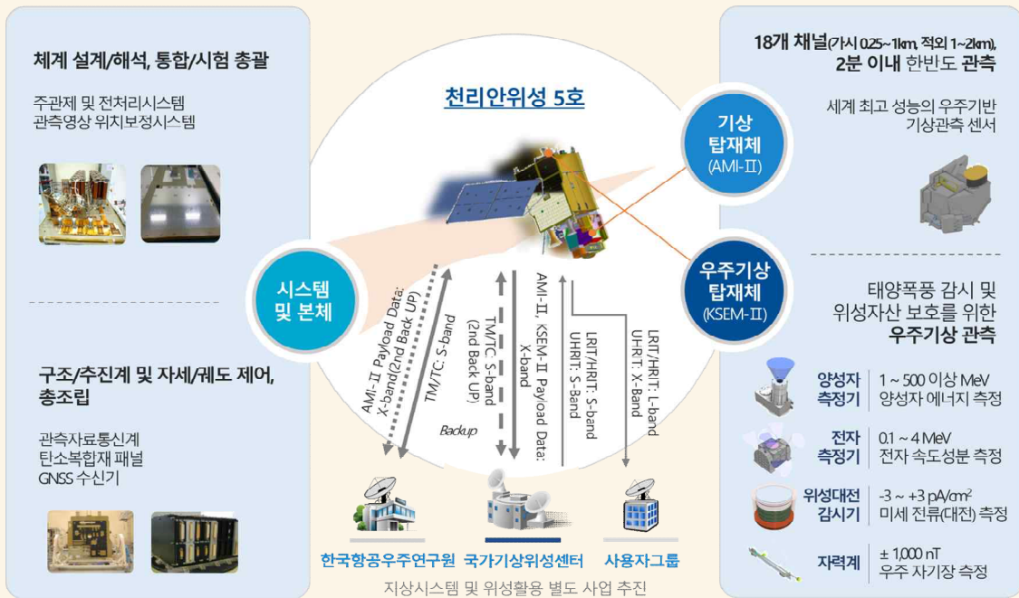
[그림 1] 정지궤도 기상·우주기상 위성(천리안위성 5호) 시스템 구성(요구사항)
