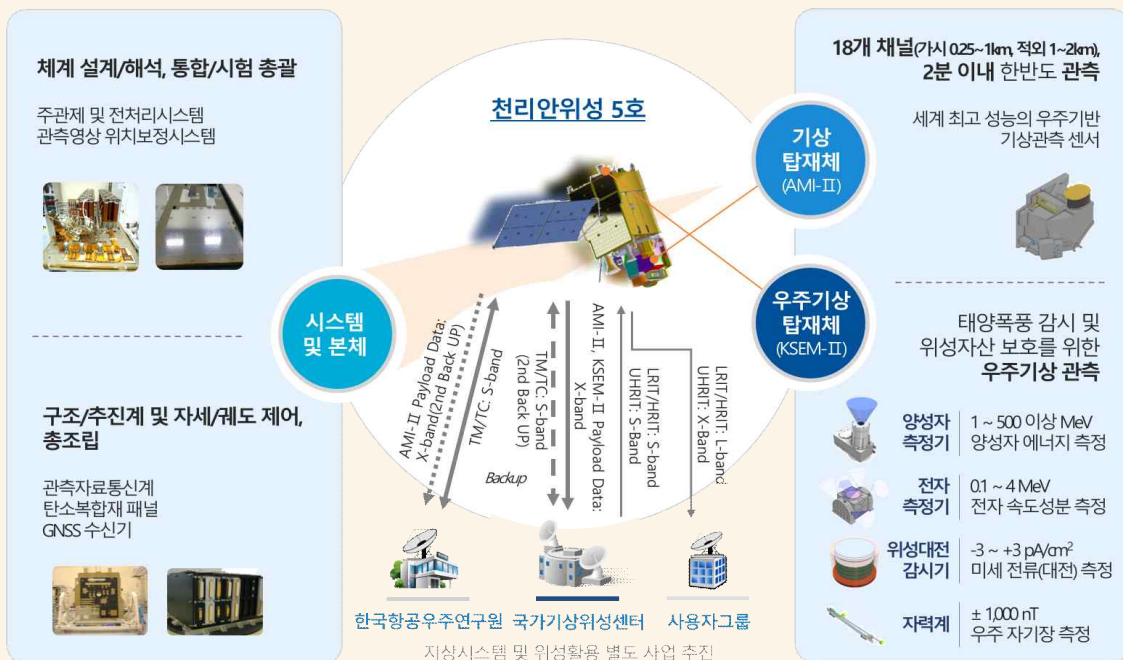
[그림 11] 정지궤도 기상·우주기상 위성(천리안위성 5호) 시스템 구성(요구사항)
