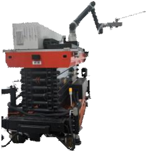
도장을 위한 협동 로봇 장착 모습
