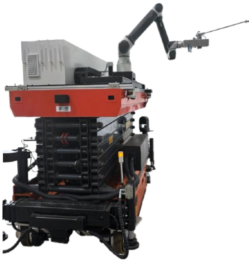
도장을 위한 협동 로봇 장착 모습
