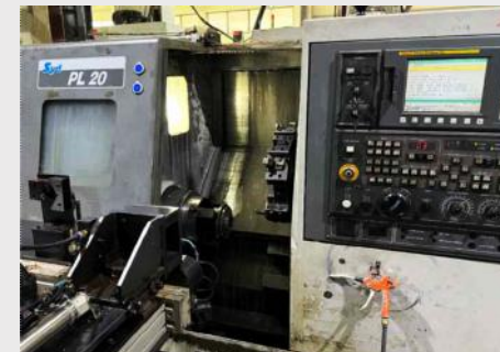
슬리브로터 주물제품을 표면가공하기 위해서는 CNC기계로 전면을 먼저 가공한 다음, 뒤집어 후면을 가공해야 한다. 이때 기계와 공작물에 남아있는 절삭칩을 에어블로어를 이용하여 제거해야 한다.
