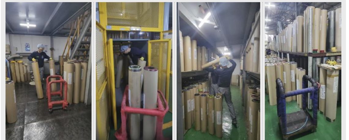
동판 중량은 15~25Kg으로 최대 4개 롤을 운반기구에 실어서 적재 위치까지 인력으로 이송
