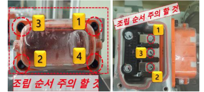
커넥터 외부 볼트 및 고전압부 볼트 체결
