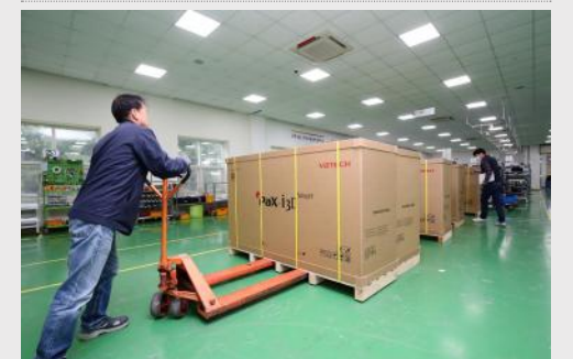
포장이 완료된 제품을 일일이 사람 손으로 옮겨야 하며, 이 과정 중 제품 파손 및 작업자 부주의로 인해 안전사고 발생 가능성이 있다.
