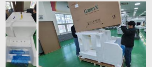
제품 보호를 위한 EPS 결합 및 완제품 포장 박스 어셈블리의 단순 작업을 작업자 2명이 불편하고 무리 되는 자세로 수행 중. 이로 인한 피로 누적과 근골격계 질환 예상
