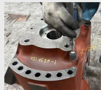
그라인딩 스톤을 사용하여 가공 측면 사상 작업
