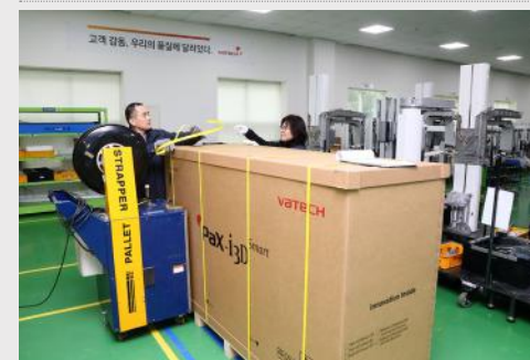
포장 박스를 작업자가 일일이 밴딩기를 통해 제품 박스를 고정하고 있으며, 밴딩기 사용 시 발생하는 열과 유해한 연기로 인해 작업자 호흡기 질환이 우려
