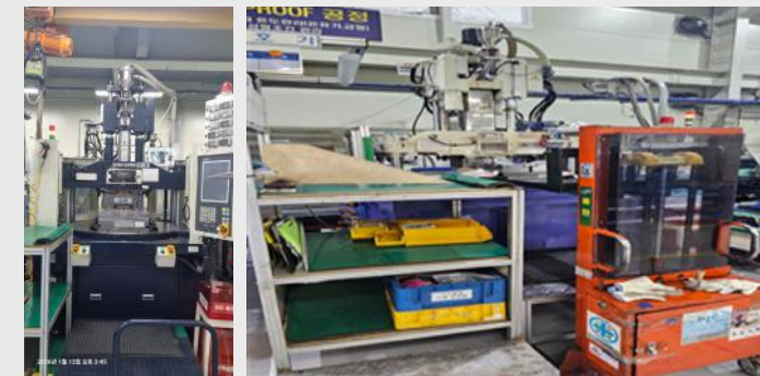
사출작업시 금형교체, 부품의 금형 내 안착 및 취출시 안전사고 발생 가능성
