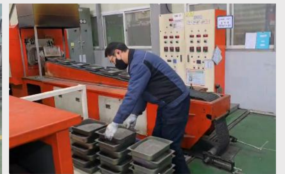
열처리 분말 바트 및 열처리 공정 제품을 컨베이어 위에 수작업 투입/배출 작업
